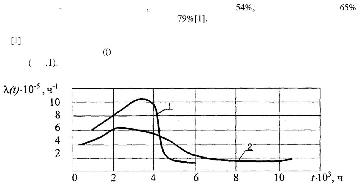
Рис.1. Интенсивность отказов щеточно-коллекторных узлов авиационных машин постоянного тока
