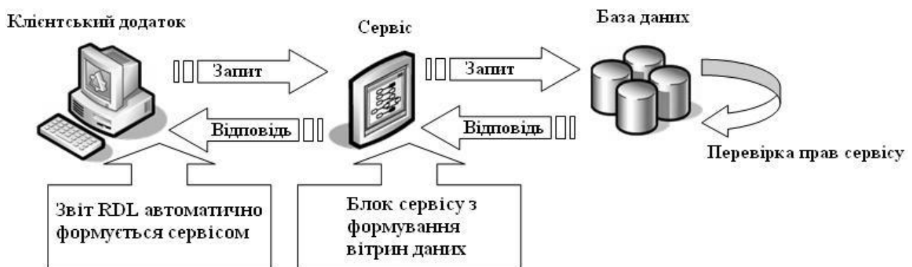
Рис. 3. Схема мережевої архітектури з трьома рівнями доступу до бази даних із вбудованим модулем формування вітрин даних на RDL каркасі
