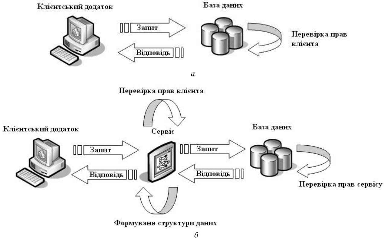
Рис. 1. Схема мережевої архітектури: а – з двома рівнями доступу до бази даних; б – з трьома рівнями доступу до бази даних
