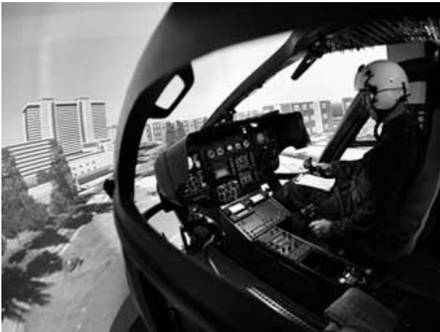
Рис. 2. Тренажер для підготовки пілотів військових транспортних вертольотів EC725 Cougar
