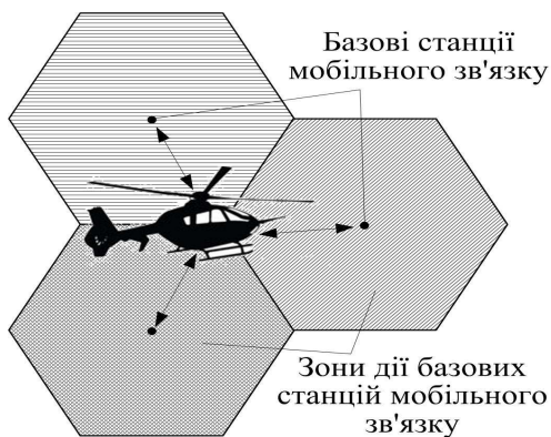
Рис. 2. Використання мережі базових станцій мобільного зв'язку для контролю засобів легкої авіації
