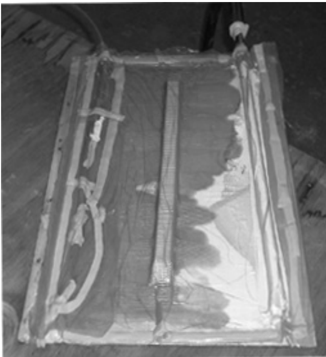
Рис. 1. Панель із пінопластовим стрингером
