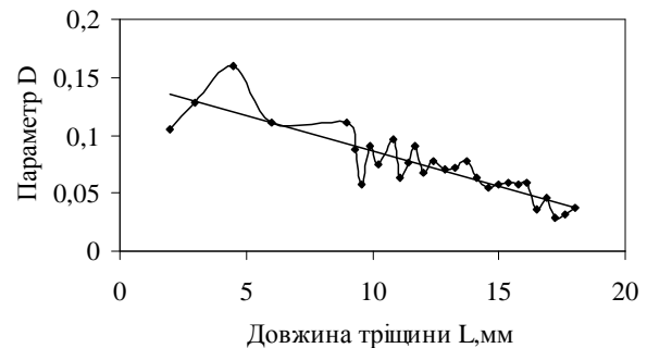
Рис. 2. Залежність параметра пошкодження у кінчику тріщини від довжини тріщини при \sigma_{\max} = 39,24 МПа
