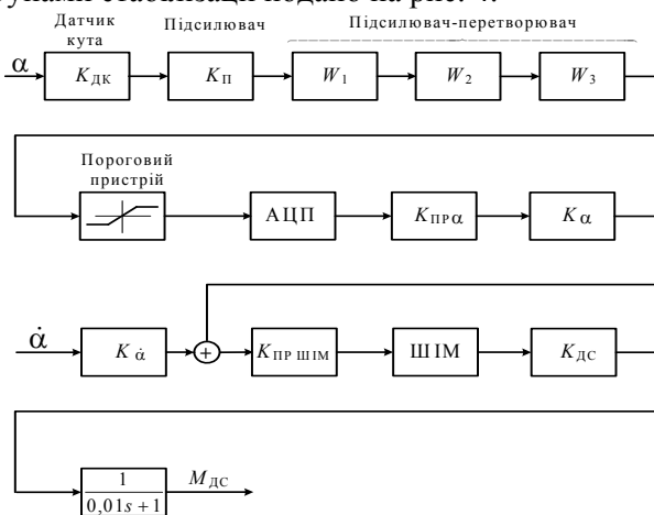
Рис. 4. Структурна схема моделі каналу формування моментів керування двигунами стабілізації: АЦП – аналого-цифровий пристрій
