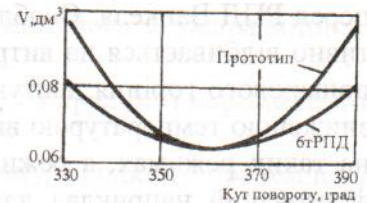
Рис. 2. Динаміка зміни об'єму камери двигуна бтРПД і його прототипу
