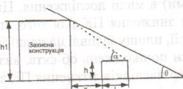
Рис. 2. Повне екранування цільового об'єкта
