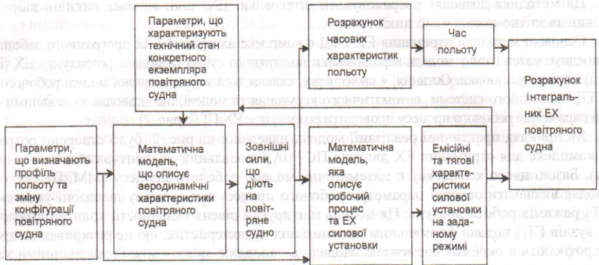
Рис. 1. Схема комплексу розрахунку інтегральних ЕХ ГТД
