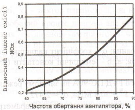
Рис. 3. Залежність параметра EI_{NOx}/EI_{NOx}^B від частоти обертання вентилятора
