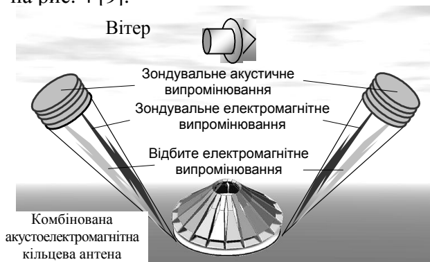
Рис. 4. Похиле радіоакустичне зондування атмосфери з використанням статичної комбінованої кільцевої антени
