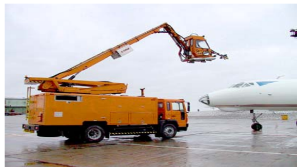
Рис. 2. Нанесення протиоблідувальної рідини на поверхню літака в аеропорту
