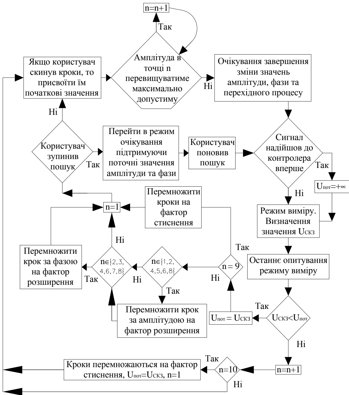
Рис. 2. Принцип дії контролера, що реалізує алгоритм шаблонного пошуку: n – номер точки сітки; U_{СКЗ} – виміряне середньоквадратичне значення віброприскорення; U_{пот} – поточне найменше значення середньоквадратичного віброприскорення
