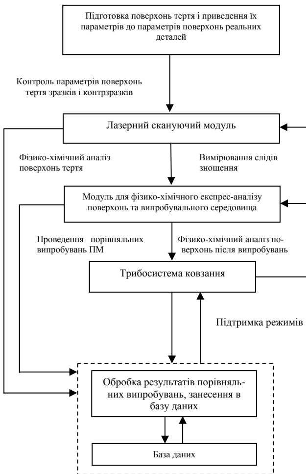
Рис. 2. Алгоритм вирішення завдань щодо проведення випробувань мастил
