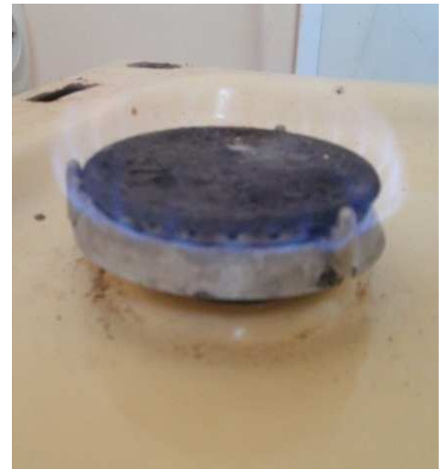
Рис. 7. Утворення біогазу (м 3 /добу) однією модульною системою газогенератора ВП-1 за перший рік експлуатації (у липні, серпні) – (а), демонстрація отриманого газу на стандартній конфорці – (б)
