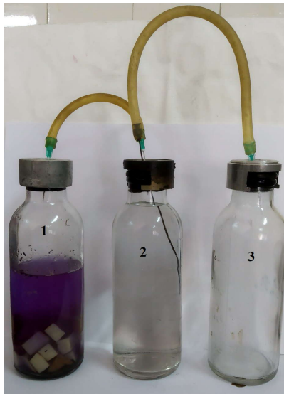
Рис. 1. Підготовлені флакони до культивування: 1 – флакон з середовищем; 2 – градуйований флакон з водою 250 мл; 3 – градуйований флакон 250 мл для прийому витісненої води
