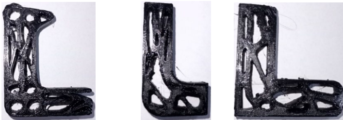
Рисунок 4. Зовнішній вигляд надрукованих на 3D принтері біонічні конструкцій кронштейна кріплення. (Джерело: отримано автором, 29.12.2023)
