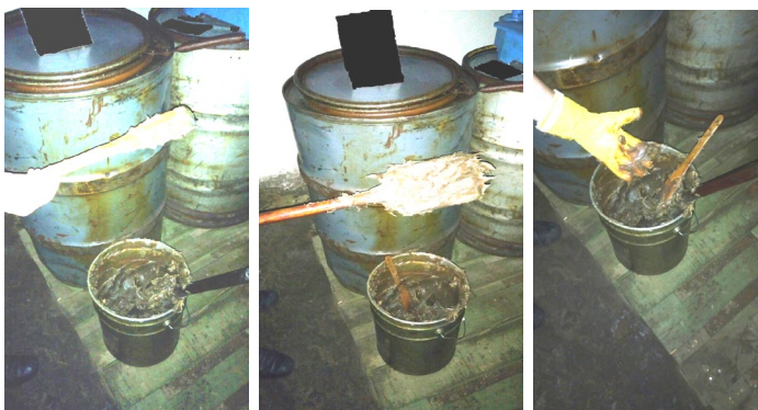
Рис. 1. Видача пластичних мастил за допомогою підручних засобів
