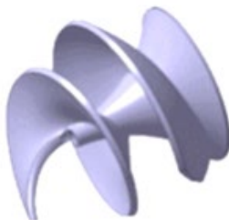
Рис. 2. Робочий орган насоса – шнек
