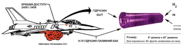
Рис. 1. Паливний бак з гідрaziном
