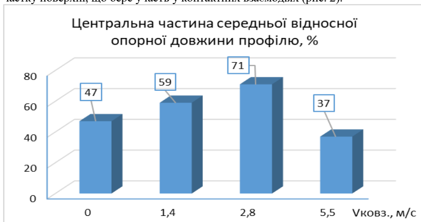
Рис. 2. Оцінка мікрорельєфу поверхні полімеру Zedex zx-100k після тертя.
