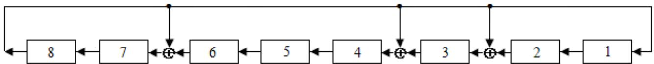
Рис 1. Структурная схема генератора Галуа над полиномом  $f_8 = 101001101$
