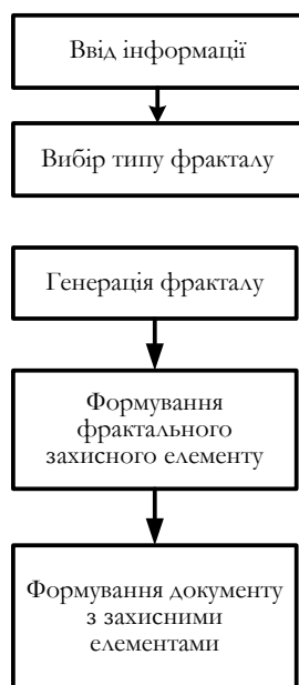
Рис. 6. Блок-схема формування захисного елемента на основі фракталу
