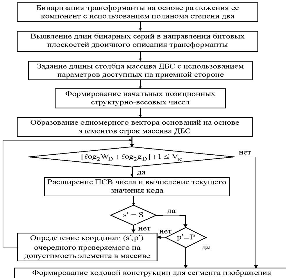
Рис. 4. Структурная схема технологии кодирования бинаризированной трансформанты
