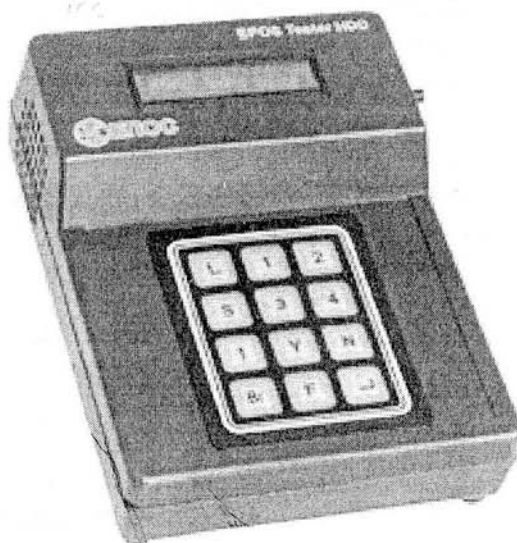
Рис. 2. EPOS Тестер HDD с реализованным программно-аппаратным методом уничтожения информации перезаписью
