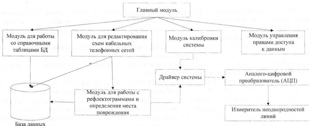
Рис. 1. Структура системы автоматизированного поиска повреждений и несанкционированных подключений к кабельным телефонным сетям.
