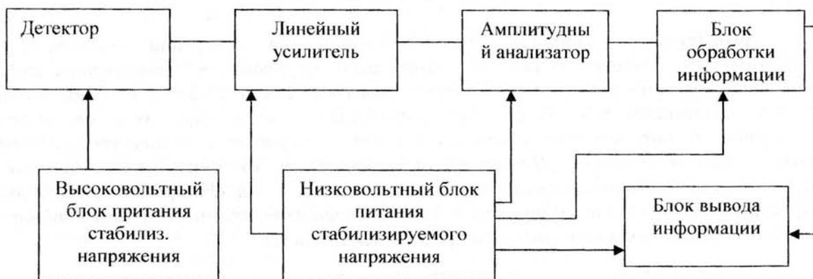
Рис.3. Блок-схема спектрометра.
