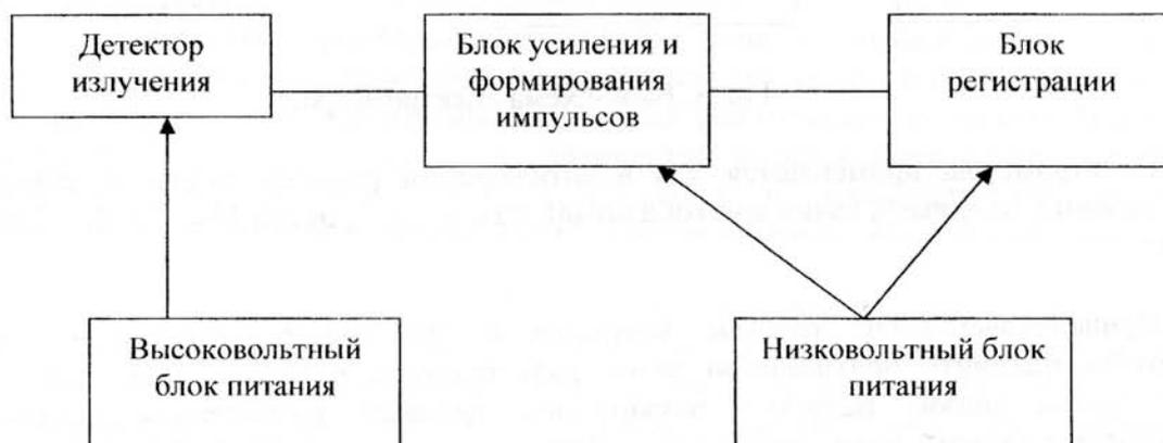
Рис.2 . Блок-схема дозиметра
