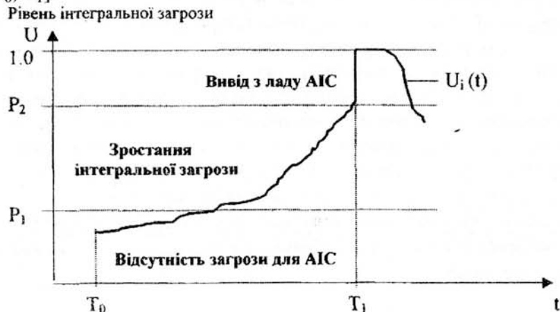
Рис. 1.2. Гіпотетичний приклад з оцінки зростання рівня інтегральної загрози U на інтервалі [T_0, T_1]
