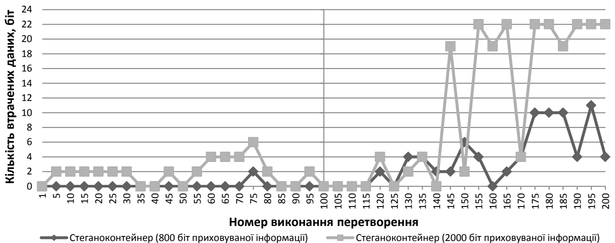
Рис. 5. Результати по вилученню даних з стеганоконтейнера після виконання перетворення пропорційного масштабування
