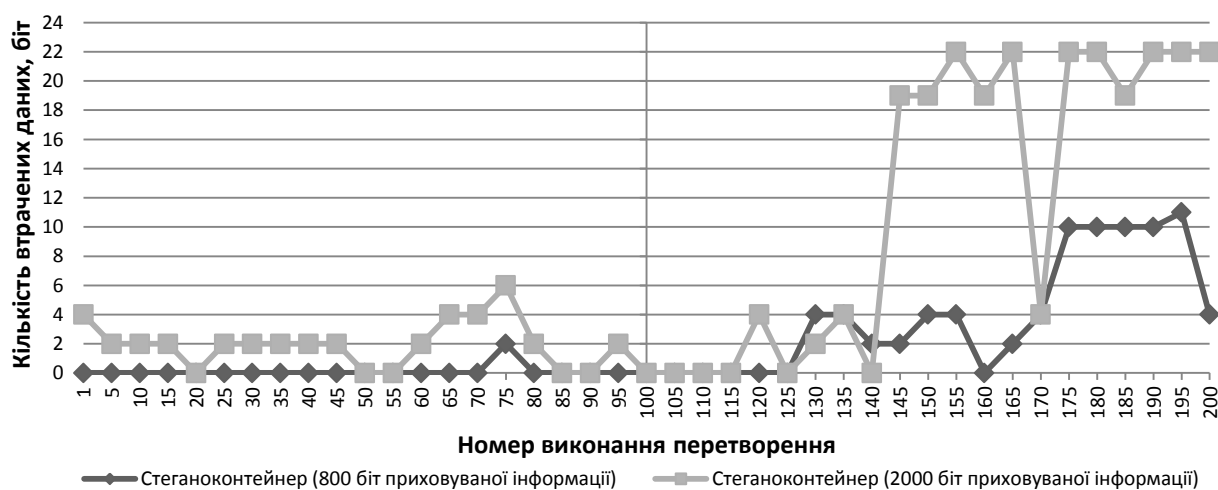
Рис. 7. Результати по вилученню даних з стеганоконтейнера після виконання перетворення непропорційного масштабування по осі ординат
