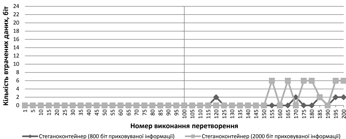
Рис. 6. Результати по вилученню даних з стеганоконтейнера після виконання перетворення непропорційного масштабування по осі абсцис
