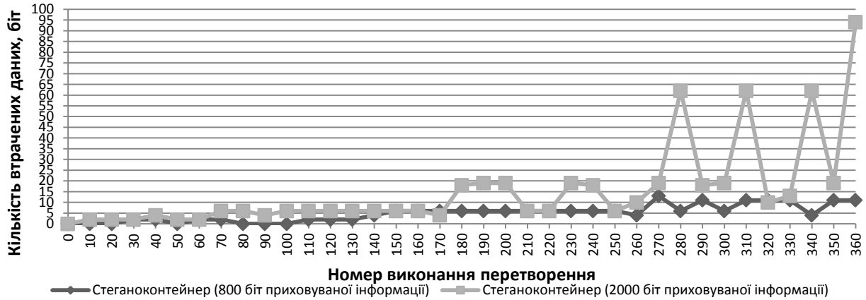
Рис. 2. Результати вилучення даних з стеганоконтейнера після виконання перетворення повороту
