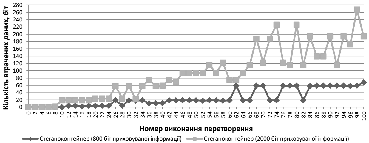
Рис. 4. Результати вилучення даних з стеганоконтейнера після виконання перетворення зсуву за віссю ординат
