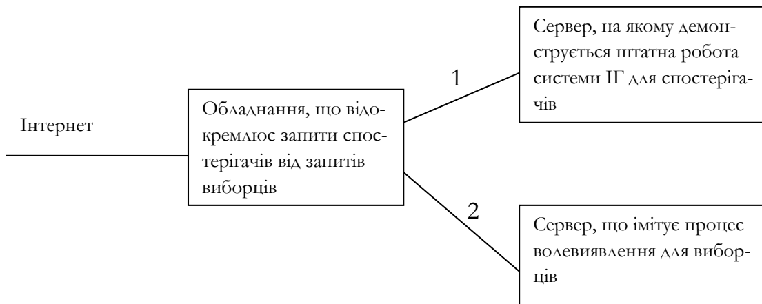
Рис. 3. Схема підключення обладнання для здійснення атаки посередника
