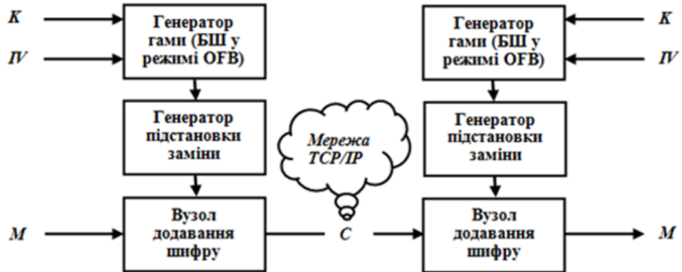
Рис. 1. Схема шифрованого зв'язку із застосуванням БАЗ
