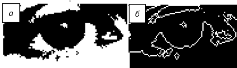
Рис. 3. Бинаризованное изображение глаза и результат выделения контуров
