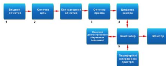
Рис. 3. Принцип дії гіперспектральної камери
