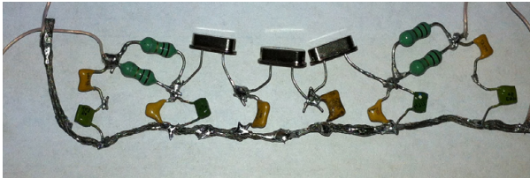
Рис. 11. Схема кварцового фільтра на навісних елементах
