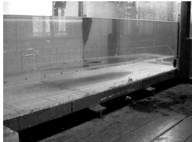
Рис. 3. Вимірювальна ділянка гідродинамічного лотка та розташування в ній пластини з лункою
