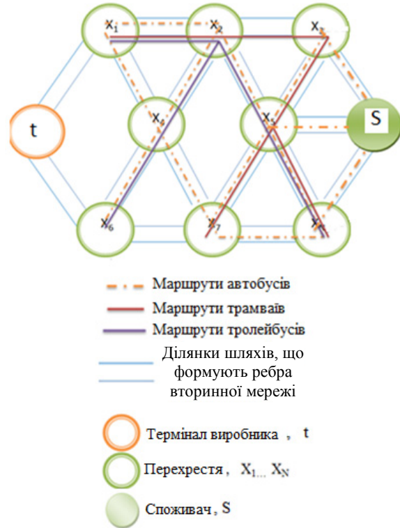
Рис. 5. Схема двошарової моделі гіпермережі транспортної системи міста
