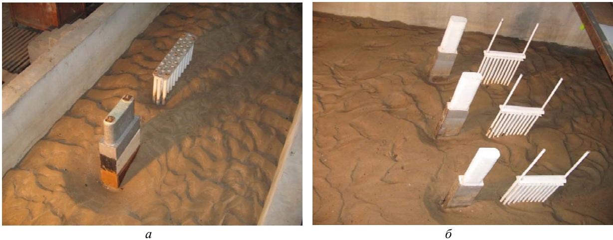
Рис. 3. Розмив ґрунту поблизу групи моделей мостових опор масштабом (а) 1:50 і (б) 1:150 до натурі
