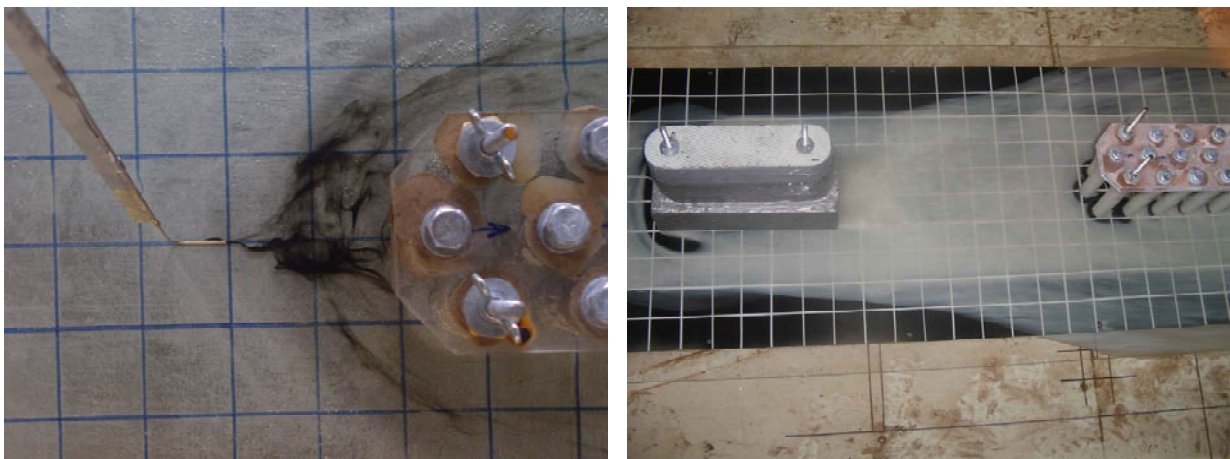
Рис. 2. Візуалізація обтікання моделей мостових опор за допомогою (а) барвників і (б) контрастного покриття, яке розмивається водою
