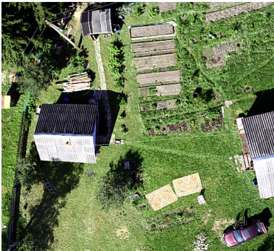
а — цифровий аерознімок БПЛА «Дозор-4» (Ленінградська обл., Росія), спектральні канали RGB, просторова розрізненість близько 2 см
