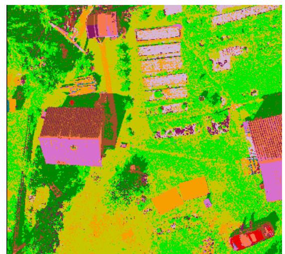
г — класифікація нормалізованих спектральних індексів в) з навчанням за алгоритмом Support Vector Machine , кількість класів 12, середня точність 86,79 %
