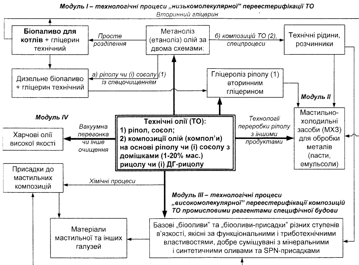
Рис. 2. Структурно-системна модель проекту комплексного перероблення технічних олій (ріпакової — ріполу, соєвої — соєолу чи рицинової — рицолу) на паливно-мастильні біоматеріали
