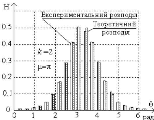
Рис. 3. Гістограма векторів ВК об'єму M = 10000 з розподілом Мізеса і параметрами k = 2 , \mu = \pi відповідно
