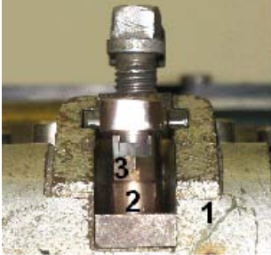
Рис. 2. Розміщення датчиків АЕ: 1 — різцетримач, 2 — широкосмуговий датчик АЕ, 3 — датчик АЕ вбудований в різець
