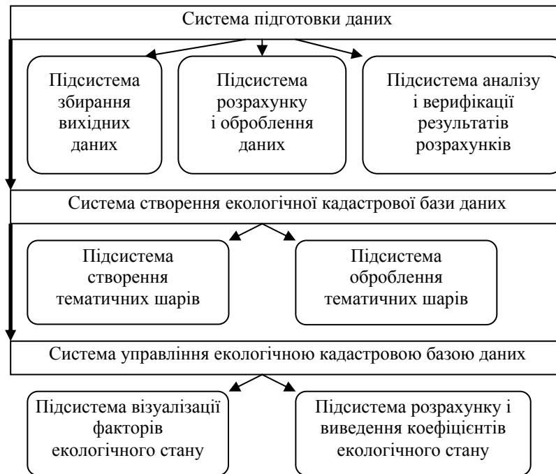
Рис. 2. Етапи застосування і роботи в геоінформаційній системі
