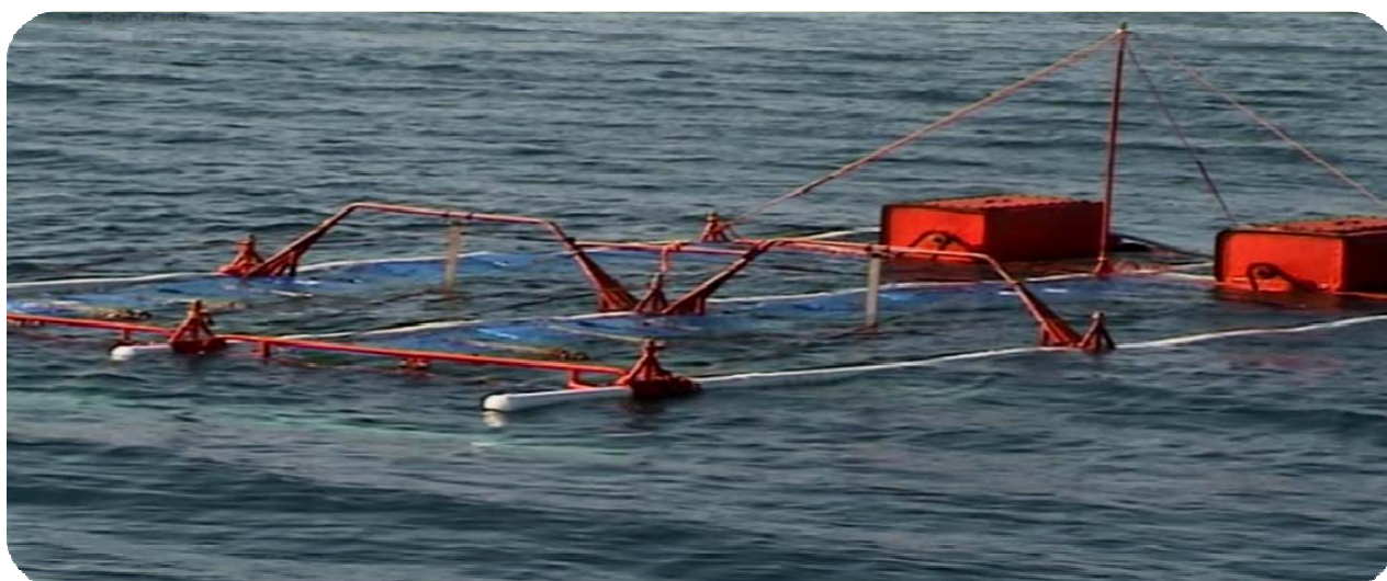
Рис. 1. Хвильова електростанція з гнучким енергопоглинальним елементом [4]
