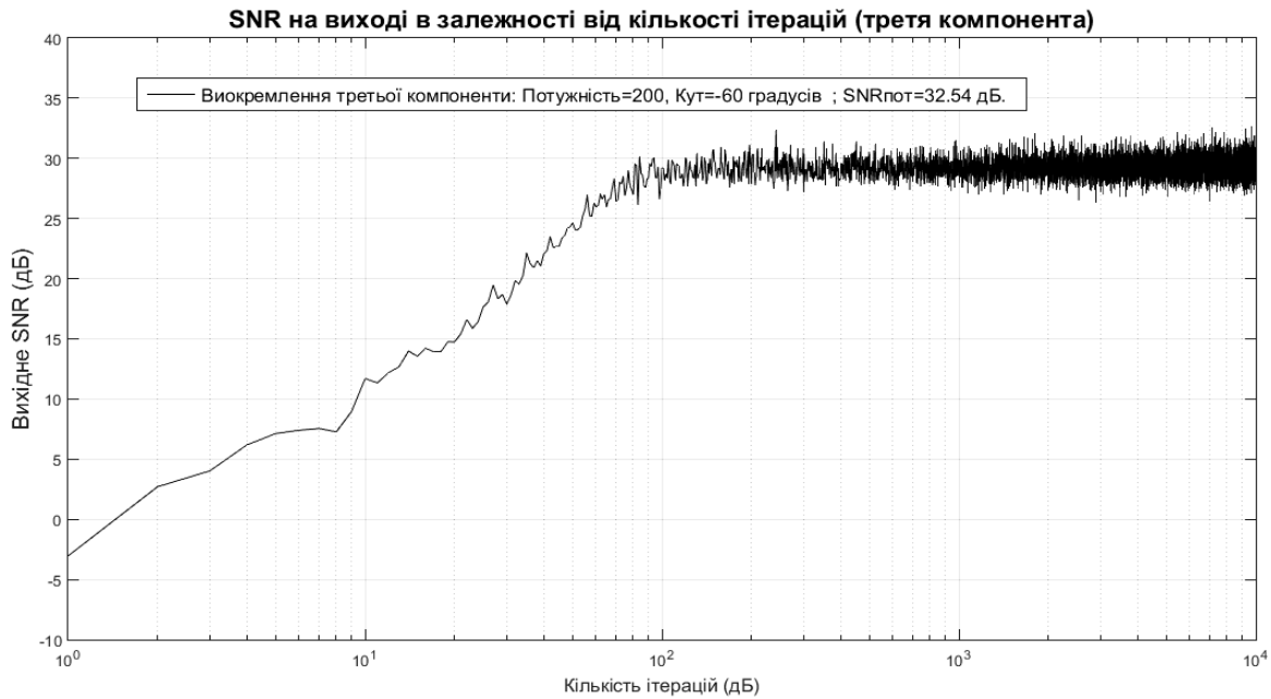
Рис. 7. Залежність вихідного SNR від кількості ітерацій для третьої багатопроменевої компоненти
