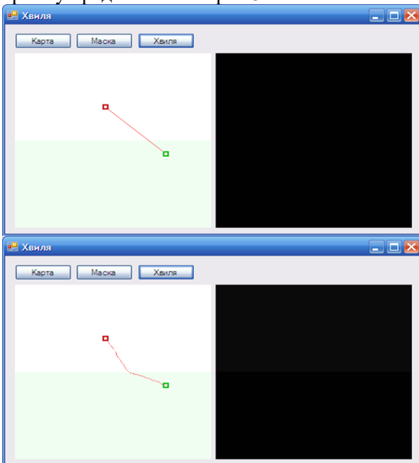
Рисунок 3 – Моделювання явища заломлення на межі середовищ з різними швидкостями поширення хвилі
