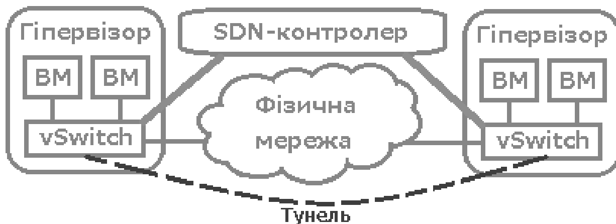
Рис. 1. Архітектура Overlay-мережі SDN
