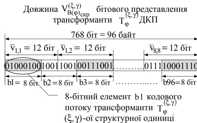
Рис. 3. Схема формування елементів по 8 біт з бітового потоку компонент трансформанти T_{\phi}^{(\xi, \gamma)} ( \xi, \gamma )-ї структурної одиниці базового відеокadra
