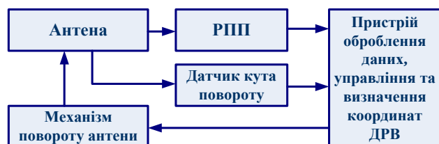
Рис. 7. Принцип побудови пеленгатора за максимумом сигналу з механічним обертанням антени
