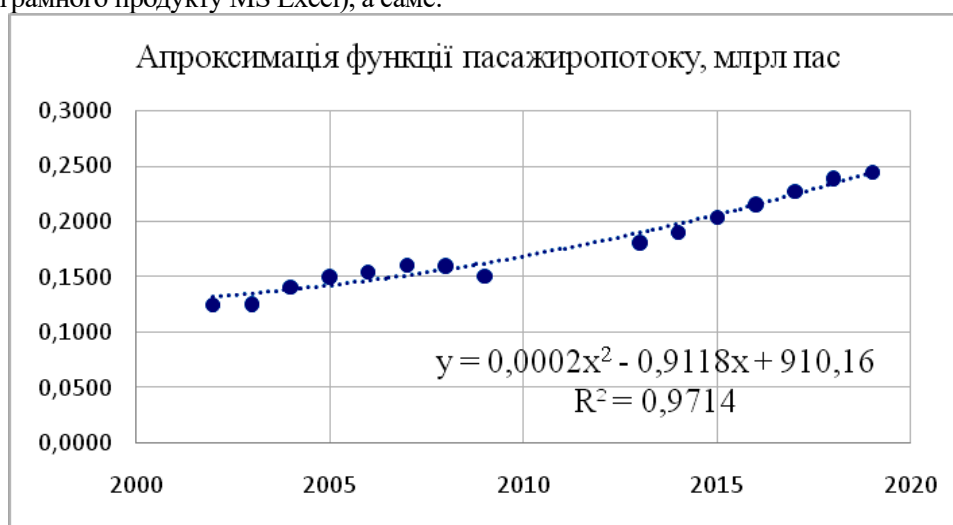
Рис. 1. Поліноміальна функція апроксимації пасажиропотоку
