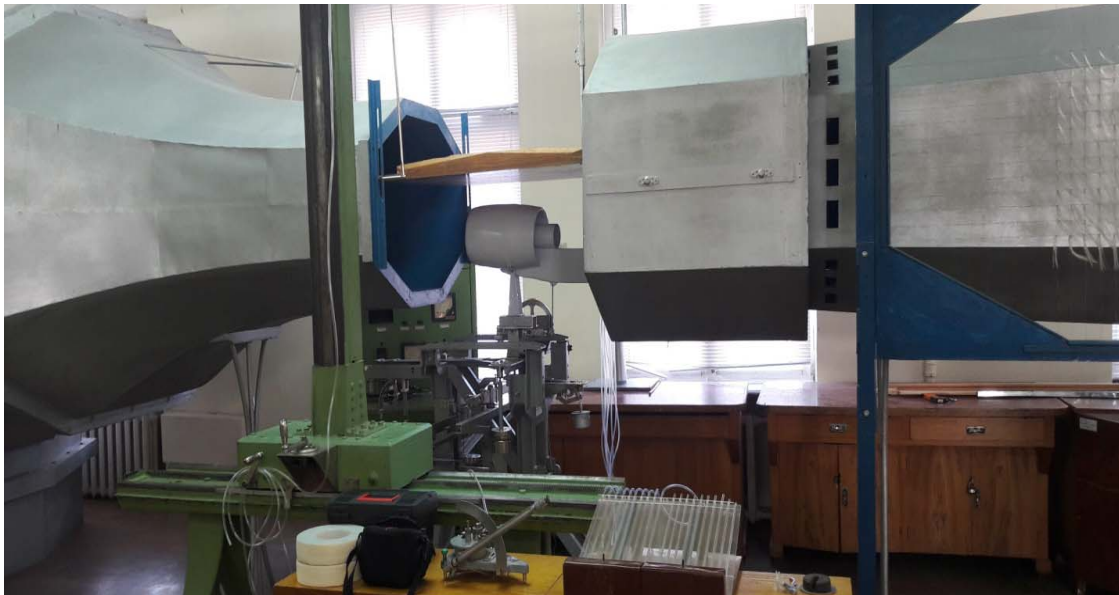
Рис. 2. Фотографія зовнішнього вигляду робочої частини АДТ Т-1 з моделлю ТРДД поблизу плоского екрану
