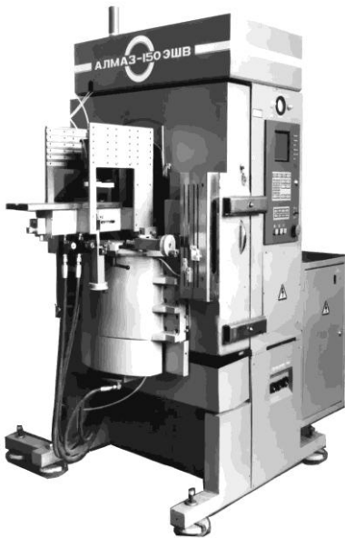
Рис. 2. Верстат автоматичного прецизійного різання “Алмаз – 150 ЕШВ”.
