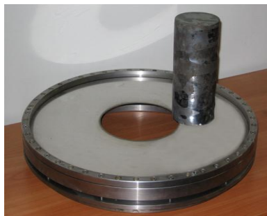
Рис. 4. Натяжний пристрій верстата з АКВР і монокристал кремнію.
