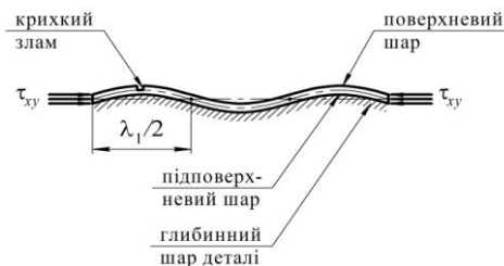
Рис. 3. Механізм крихкого руйнування поверхневих шарів деталі при хвилеподібних деформаціях (ефект руйнування деформаційних мікронерівностей): \lambda_1 – довжина хвилі деформації.
